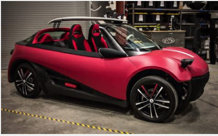
LM3D von Local Motors: Fahrgestell und Karosserie sind größtenteils mit dem 3D-Drucker gefertigt.
