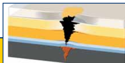
La conseguenza: Formazione di ruggine sotto la vernice.
