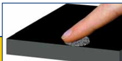
Ruggine causata da una contaminazione: La ruggine può nascere anche da un'impronta su una lamiera nuda.
