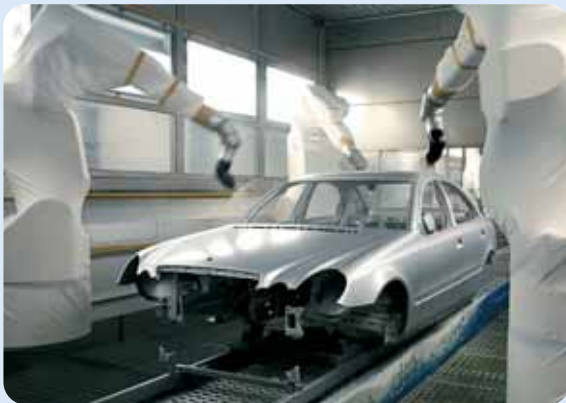
Acabado mecánico robotizado.
