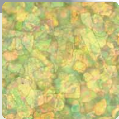
Análisis bajo el microscopio para determinar las partículas de efecto de una pintura.
