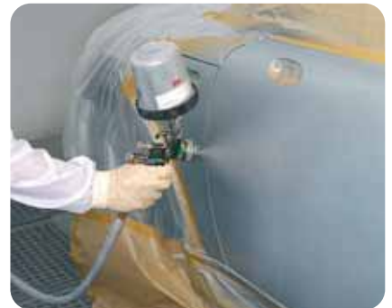
Aplique barniz en toda la pieza. Asegúrese de que el barniz se aplica en una capa fina en la zona contigua a la pieza adyacente.
