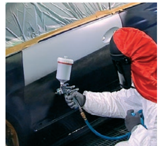
カラーブレンドの使用は周囲の塗装面にスムーズにボカシ塗装を行うための確実な方法です。
