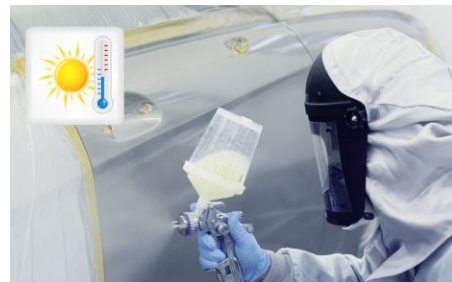
Hohe Temperaturen und sehr hohe (oder sehr niedrige) Luftfeuchte machen das Lackieren im Sommer nicht selten zu einer Herausforderung.
