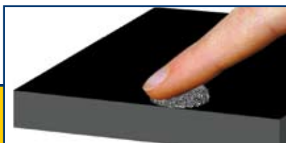
Rdza spowodowana zanieczyszczeniem. Rdza tworzyć się może nawet po dotknięciu palcem gołej blachy.
