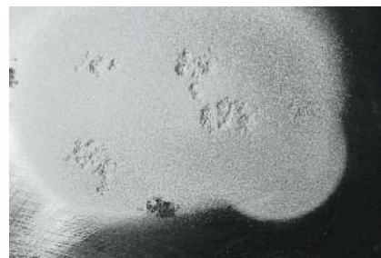
Gniazdo korozji trzeba jeszcze oczyścić metodą piaskowania i gotowe.
