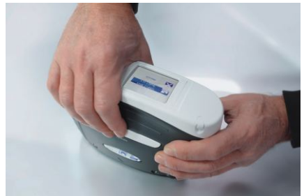
Farbtonbestimmung mit Genius-Messgerät
