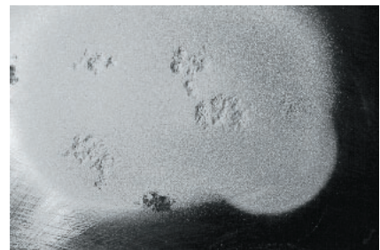
Cualquier resto que haya quedado (inferior centro) se ha de someter al chorro de arena antes de proseguir con el siguiente paso del tratamiento.
